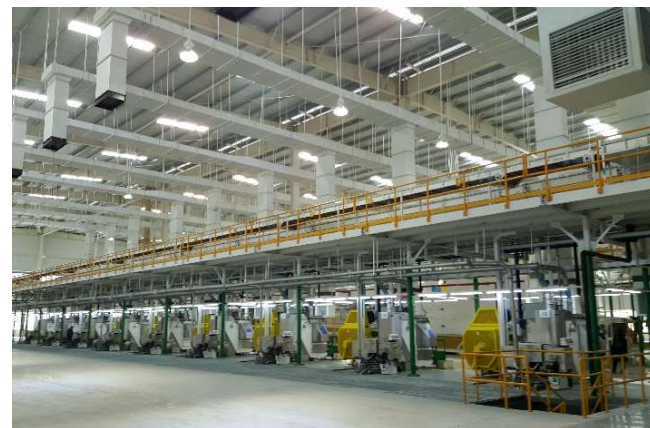
美國Stolle高速產線(鋁罐) 每分鐘最快可達3000罐
